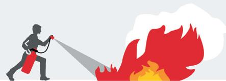
Stoßweise löschen! Nur so viel Löschmittel einsetzen, wie zur Ablöschung erforderlich ist. Löschmittelreserven für evtl. Wiederentzündungen bereithalten.
